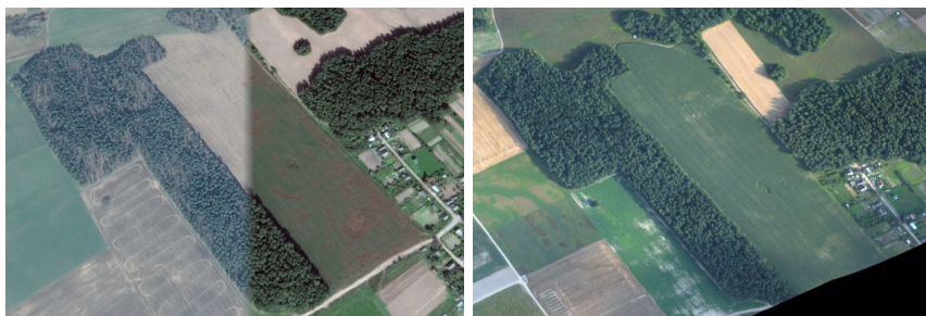
Рисунок 1 – Данные разных съемочных систем на поле размером около 10 га: а – со спутника Landsat 8 за 22.07.2014 (пространственное разрешение 30 м); б – с белорусского спутника за 15.07.2014 (пространственное разрешение 10 м); в – со спутника QuickBird за 19.04.2014 и 17.09.2014 (пространственное разрешение 2,4 м); г – авиационная съемка за 24.07.2014 (пространственное разрешение 0,2 м)
